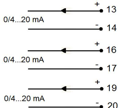
**Fig. 14. Analog outputs.**
